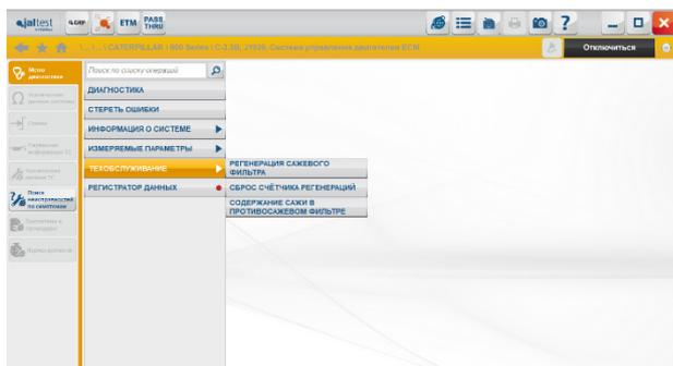
+ Новая система снижения токсичности ARD (Устройство регенерации отработавших газов).
