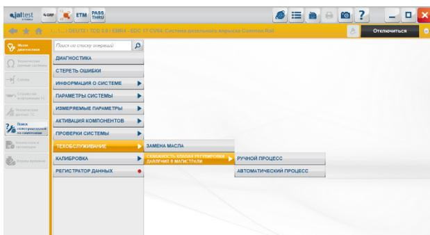
EMR4 система управления двигателем, сервисная регенерация системы снижения токсичности CRT с электронным блоком EDC 17 CV52; кодирование инжекторов, сброс адаптаций по клапану регулирования давления впрыска и многие другие функции в системах EDC 17 CV54.
